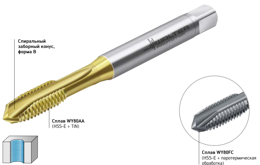
Метчики Walter Prototyp TC216 Perform для нарезания резьбы в сквозных отверстиях
